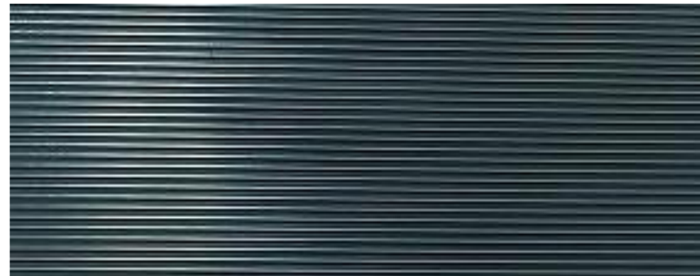
長期発電試験3000時間以上達成サンプル (Ti薄膜+DLC膜 評価前外観図)
